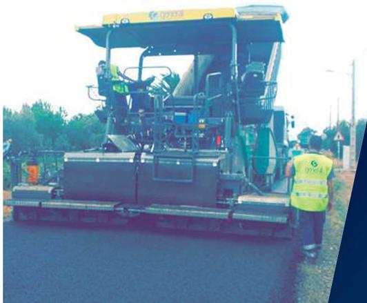
Repsol ha desarrollado la emulsión bituminosa de rotura media **C67B3 MBA EFIMUL**, formulada ad-hoc para la fabricación de mezclas de granulometría abierta, acopiadas, manejables a temperatura ambiente, y específicamente diseñada para aprovechar la versatilidad y movilidad que ofrece la maquinaria de fabricación y extendido de lechadas bituminosas.
